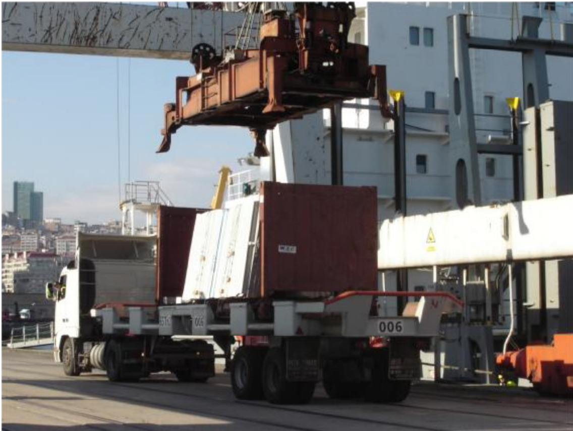
Figura 2. Operación dentro del THC. Spreader preparado para el enganche.
