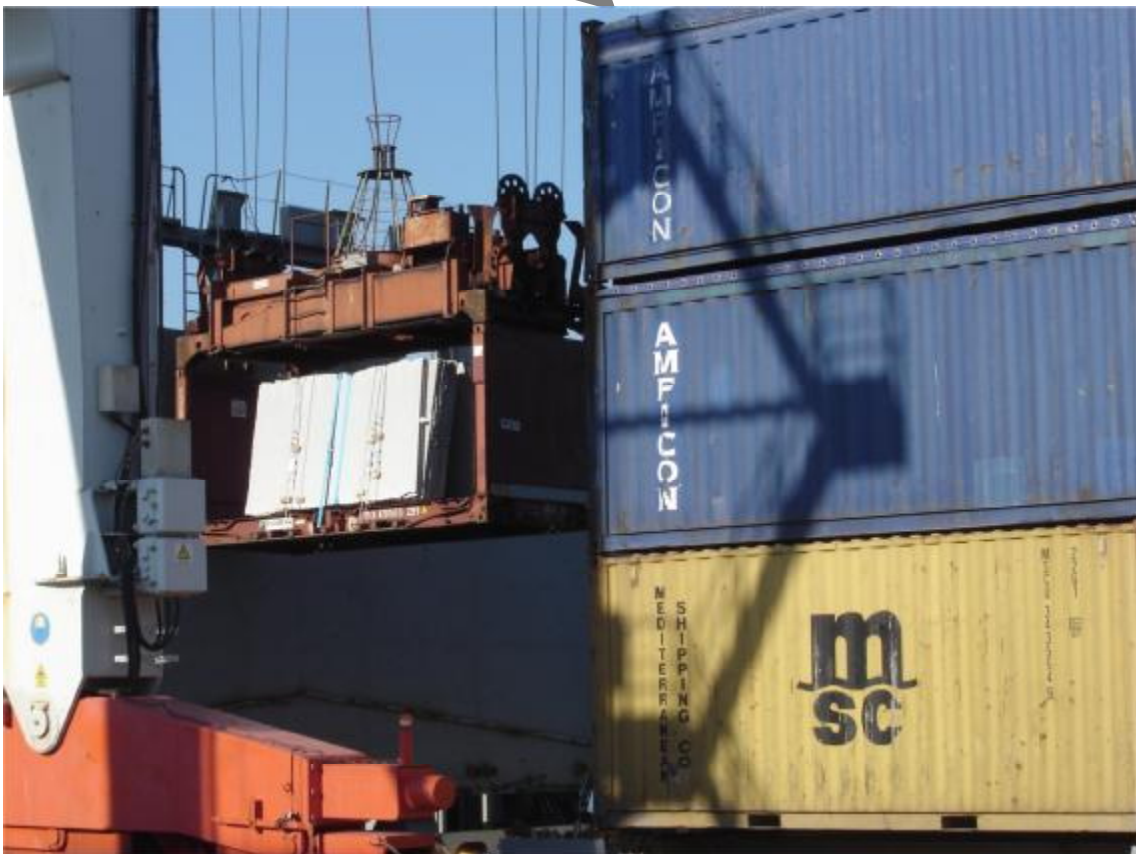
Figura 3. Operación dentro del flete. Bajando a la celda correspondiente.
