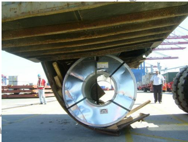
Siniestro por concentración de carga en poca superficie (ix).
