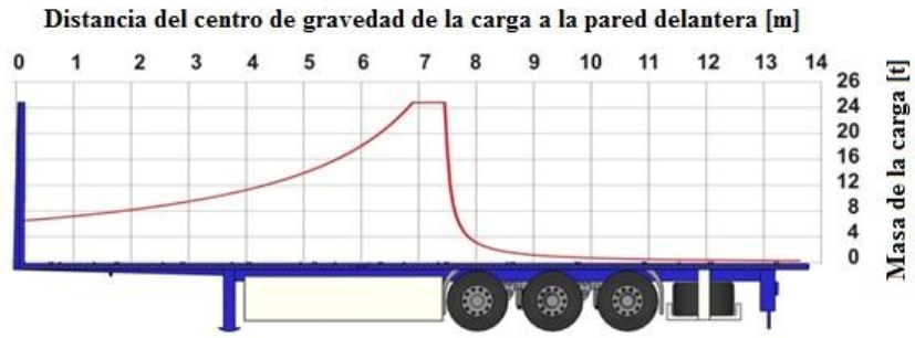
Diagrama de carga de un semirremolque de tres ejes (x.1).
